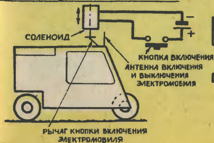
СХЕМА УДЕРЖИВАНИЯ И ВЫПУСКА ЭЛЕКТРОМОБИЛЯ ИЗ КУЗОВА АВТОБУСА
